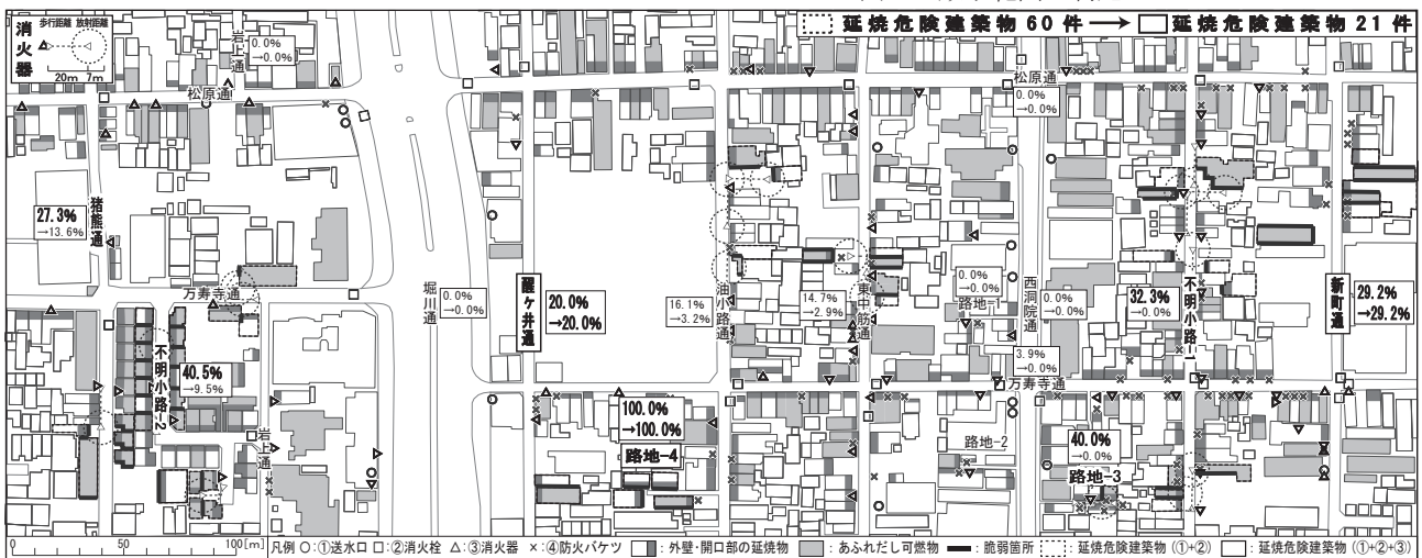
図 13. 初期消火関連機器の設置状況と延焼危険建築物のチェック結果
