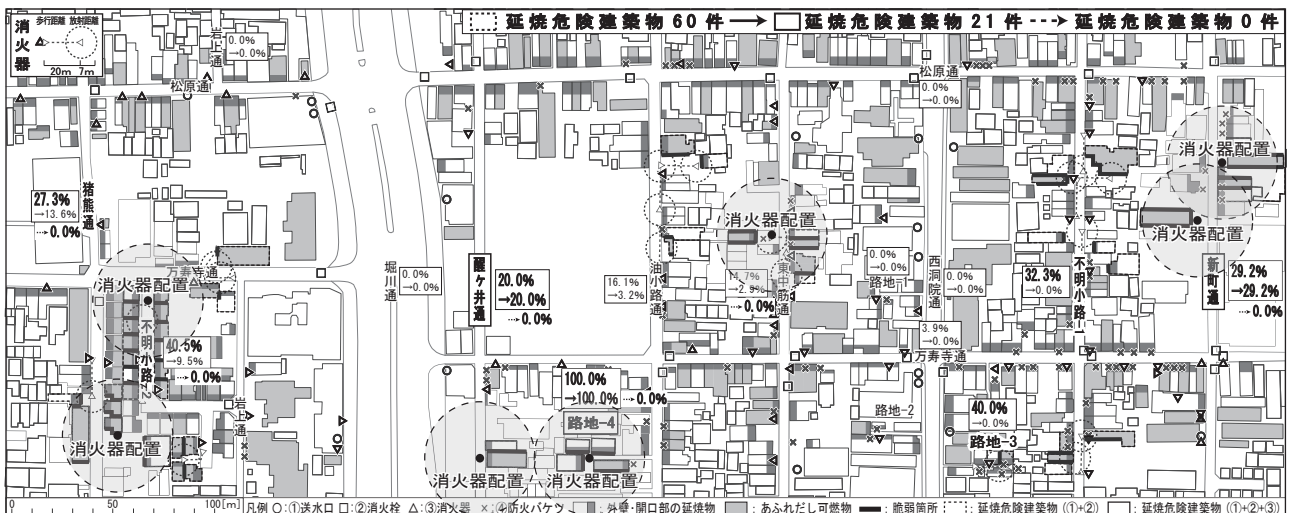
図 15. 軽微な消火器設置による延焼危険性への対応フレームの提案
