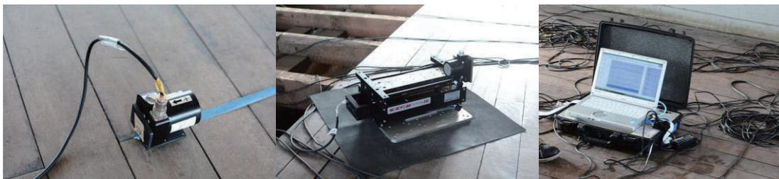
図4 微動センサー・起振機・収録装置
