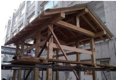
(a) 試験体建て方 (筋交は仮筋交)
