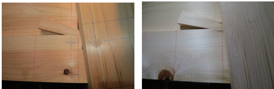
図8 板壁試験体における貫の引き抜けの様子（左：低軸力／右：高軸力）
