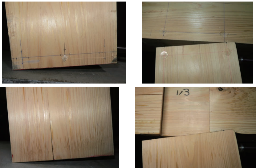
図7 板壁試験体の終局時の柱頭柱脚の様子（上：低軸力／下：高軸力）
