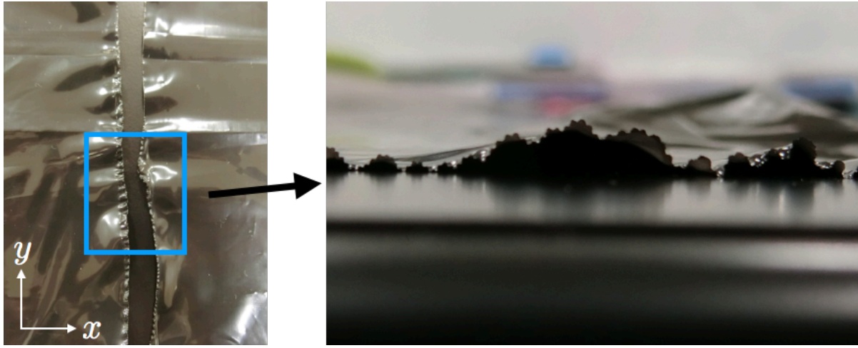
図 2.11. プラスチック性のシートを引き裂いた時の引き裂き面のパターン。引き裂かれた面は引き延ばされ塑性変形を起こしている。
