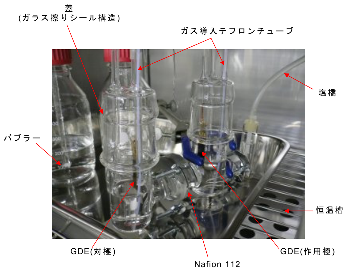
Figure 36 触媒溶解量測定装置 C の外観(恒温槽内に設置)
