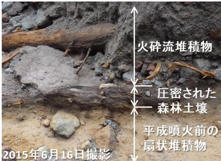
図－27 火砕流堆積物の下で圧密された森林土壌の状況
