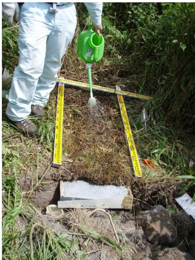
図一 51 浸透能試験における散水状況
