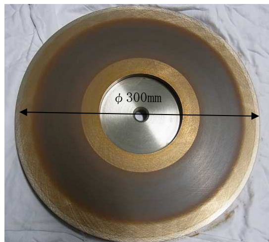
図 2.9 使用後の目切り溝無し鑄鉄定盤
