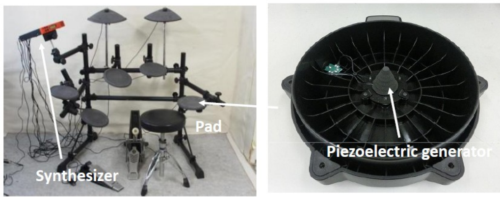
図 6-1 従来の電子ドラムとパッド構造の写真
