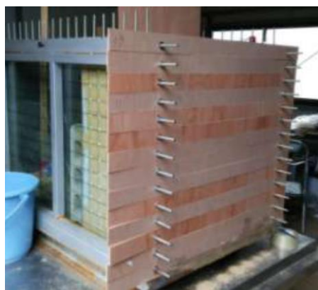
写真 付 4.1 土槽の作成状況
