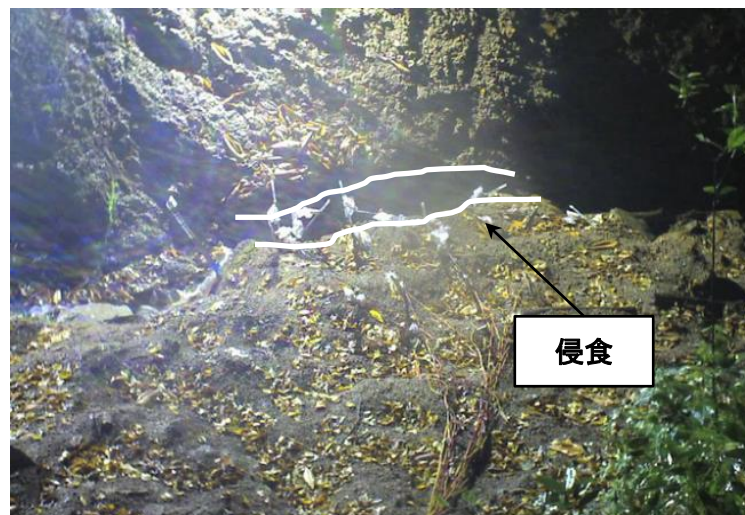
図 4-8 土砂流動化時の堆積層の様子(2013/10/11 21:00～21:10)
