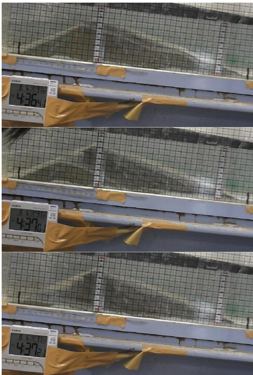
写真-3.1 Case1 の越流決壊時の様子（上：越流開始後 20sec, 中：45sec, 下：60sec）
