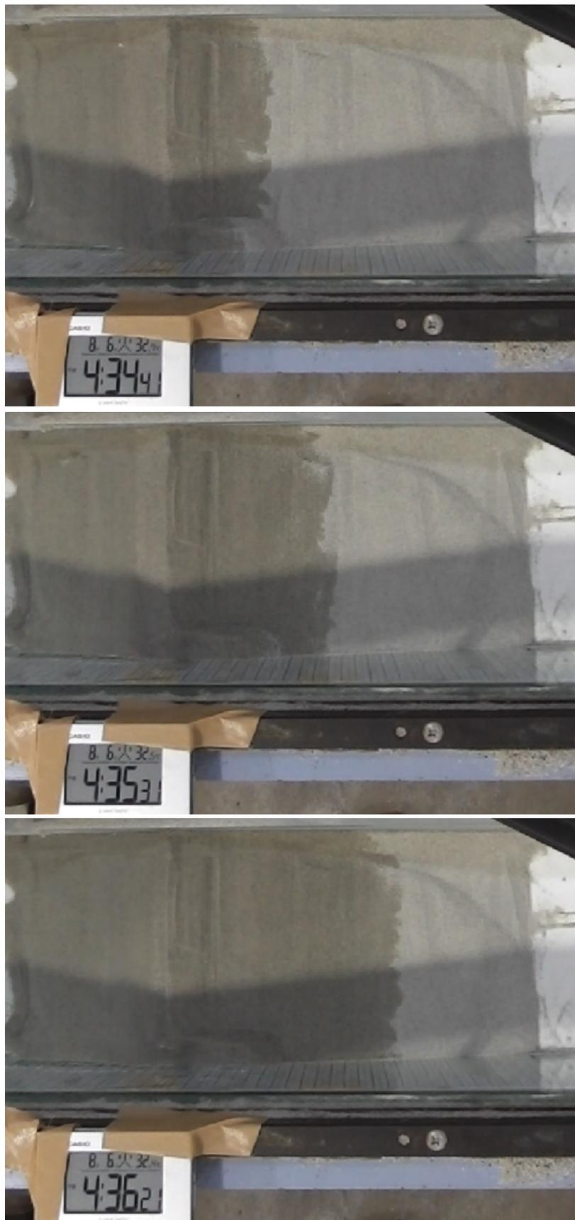
写真-3.2 Case1 の越流開始前の湿潤線進行の様子
