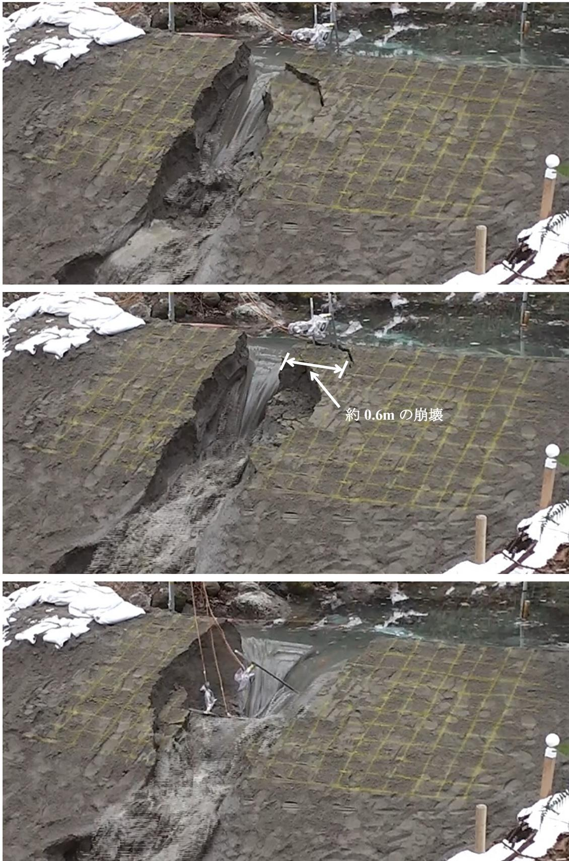
写真-4.1 Case3 の決壊状況（上：越流開始後 105s，中：110s，下：120s）
