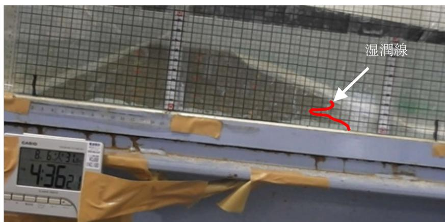
写真-3.1 越流決壊開始時の様子(Case1)
