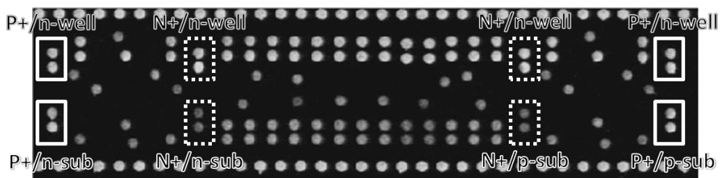
(d) 2次電子像 (FIB:12000倍, 加速電圧40kV)
