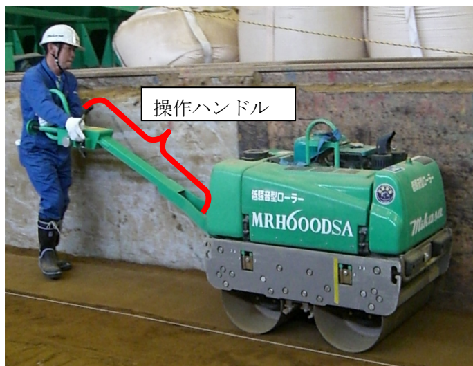
写真-2.1 ハンドガイド式締固め機械（ハンドガイドローラ）
