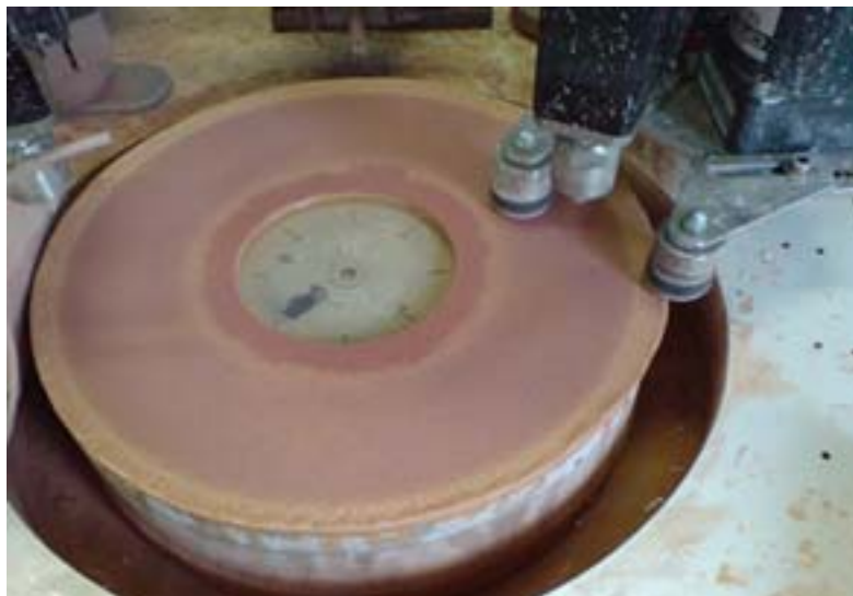
図 3.1 工作機械に付着している酸化セリウム砥粒
