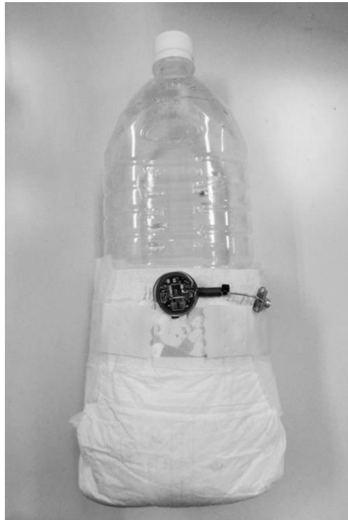
図 4-24 評価用モジュール付きのおむつをペットボトルに装着した様子
