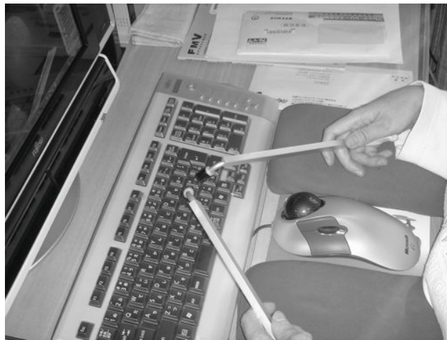
図7 タイピングエイドを使って関節可動域制限を補助するII期レベルでの例。文献[35]より引用
