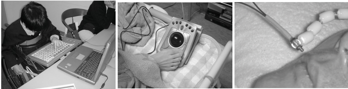
(a) I 期: 上肢機能に応じたキーボード (b) II 期: 足でのトラックボール操作 (c) III 期: 光ファイバーによる検知
