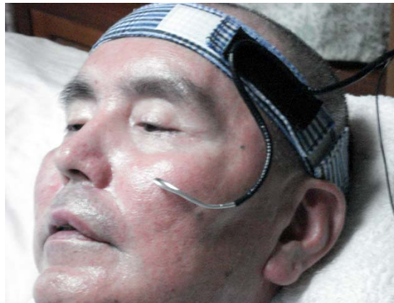
図 5-4 和中の用いる入力インタフェース (左頬を接触させ、信号を送る)
