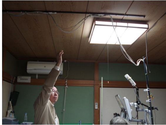
図 5-7 カーテンレールによる配線固定(天井の高さを示すため、協同研究者(初出論文における第2著者)が手を挙げています)
