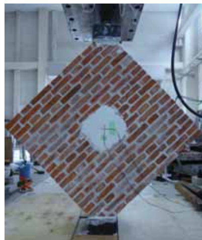
写真7 斜め圧縮試験供試体 (ひずみ計面)
