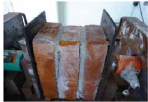
写真1 煉瓦と目地境界で破断（圧縮応力 0.11N/mm 2 ）
