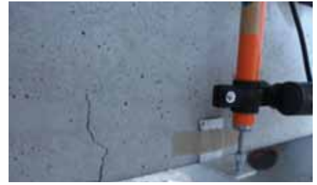
写真4 コンクリートの降伏時の状況
