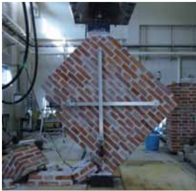
写真8 無補強供試体1 (破壊後)
