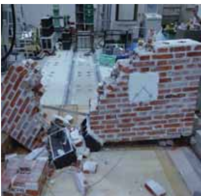
写真9 無補強供試体2 (破壊後)
