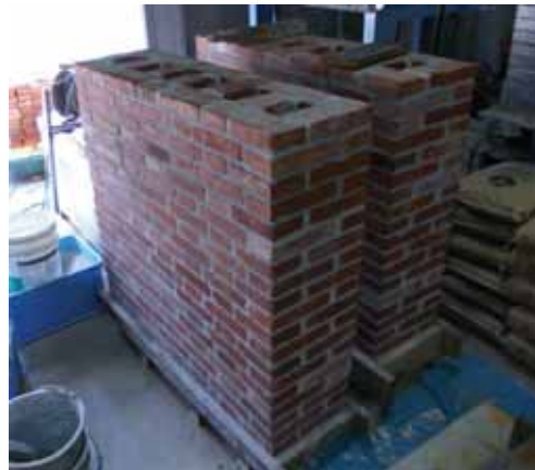
写真3 モデルを参考に作製した供試体
