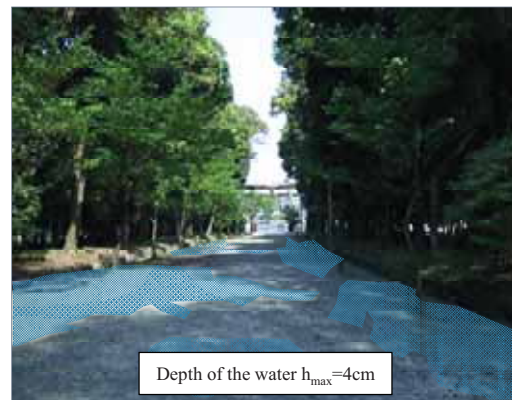
図4 洪水氾濫解析結果に基づく最大浸水予想結果 2)
