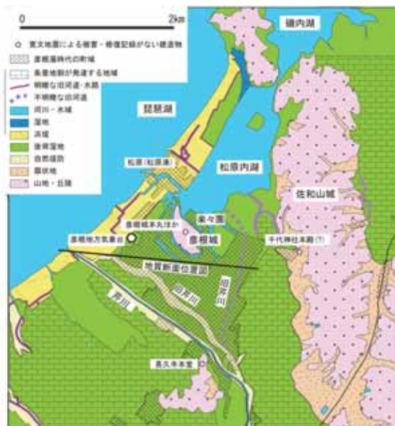
第2図 彦根市周辺の地形分類図。小松原(2006) 6) を改変。地質断面位置図に沿った断面図が第3図。
