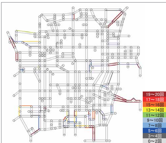
図8 ダミーリンク④・⑤からの流入交通を3分の2に抑制した場合の各リンクの渋滞回数
