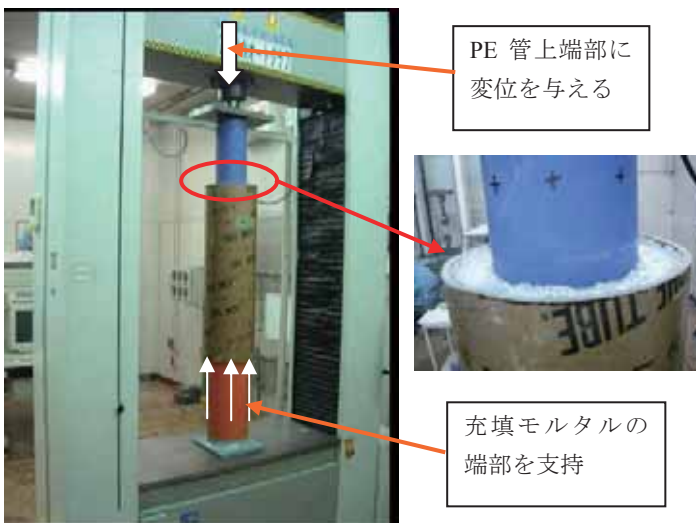
写真1 PE管-モルタル間抵抗力測定実験
