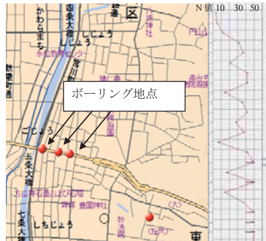
図11 五条大橋付近のボーリング図
