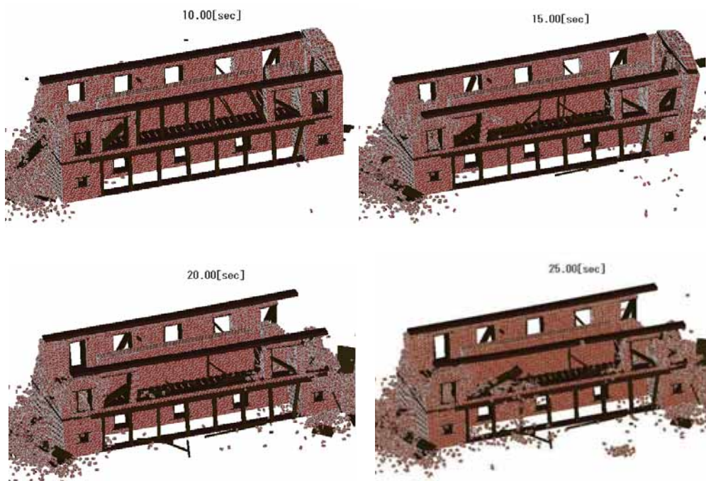
図 6 50年発生確率10%の地震動をX方向に入力した結果
