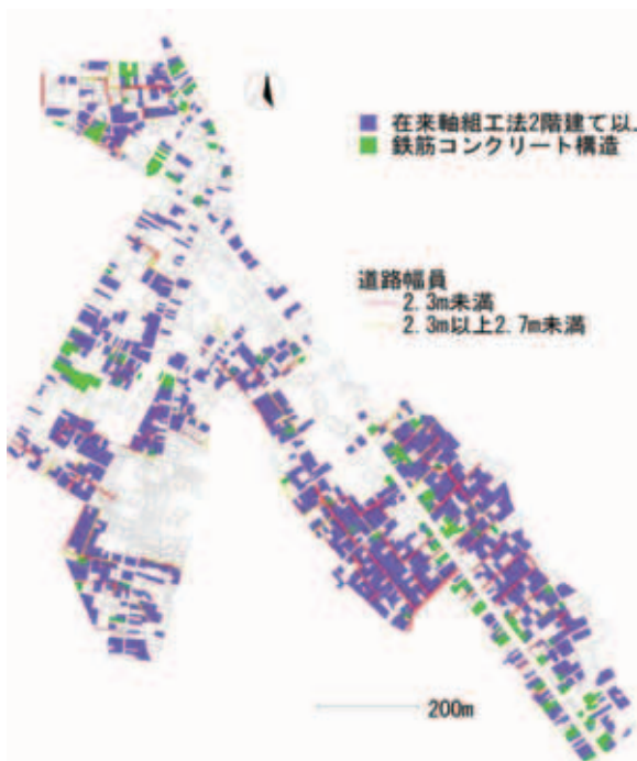
図3 在来軸組工法2階建てと幅員2.3m未満・2.3m以上2.7m未満の道路の分布
