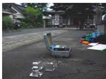
写真7 地盤の微動計設置状況 <写真提供：三辻和弥氏(東北大)>
