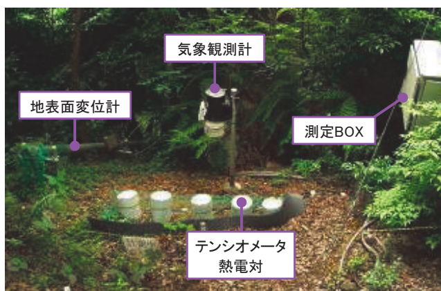
写真1 M地点の設置状況
