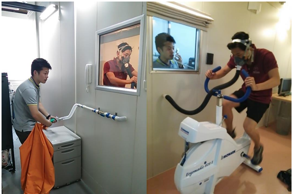
Figure 2 世界で唯一のエネルギー代謝測定室とダグラスバッグを連結した装置
